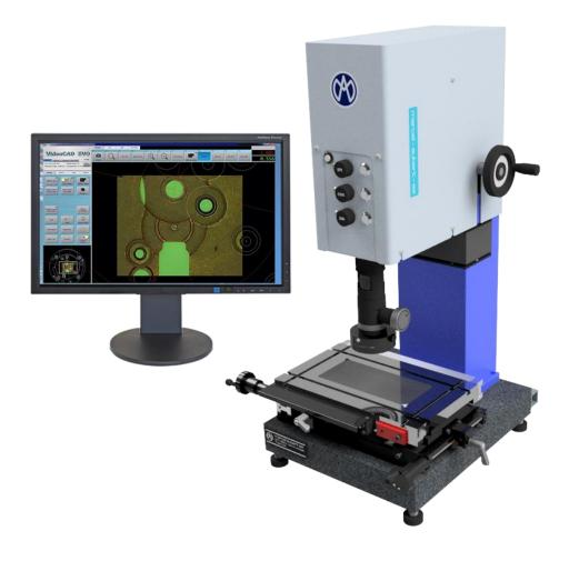
Machine de mesure d'atelier polyvalente permettant une mesure optique rapide et fiable sur différents champs visuels. Cette version carénée intègre les commandes d'éclairage, et dans le cas d'une machine motorisée, les commandes de motorisation, offrant ainsi un faible encombrement. L'ergonomie de l'appareil est ainsi optimale et l'appareil est plus compact. Le choix des optiques et des éclairages répondent aux applications les plus exigeantes.
