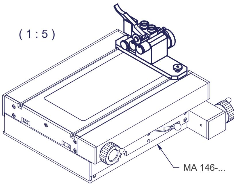
Système de mesure de la concentricité MA 146r
