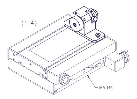
Diviseur manuel avec serrage sans clef de pièces de Ø3 à 16 mm Plaque de fixation pour table en croix MA 146
