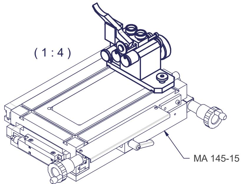
Système de mesure de la concentricité MA 145r
