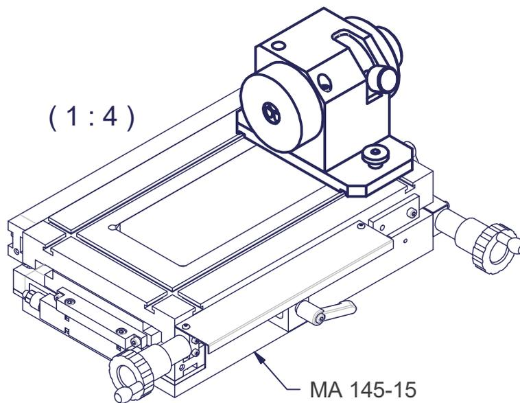
Diviseur manuel MA 145d avec serrage sans clef de pièces de Ø 3 à 16 mm:
