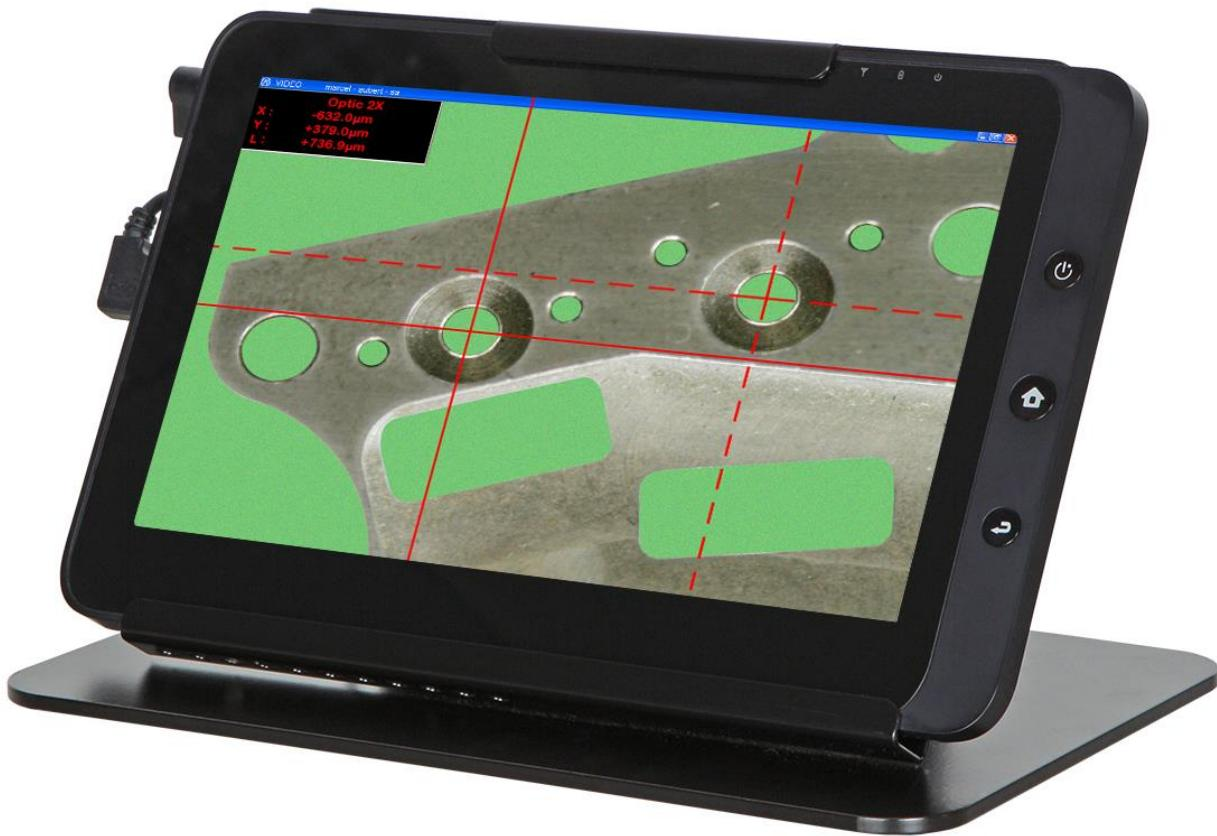
**VideoMES** ist eine einfache Softwarelösung zur Durchführung von Winkel- und Distanzmessungen. Im Modus "Winkelmessung" überlagert ein drehbares Fadenkreuz das Videobild, wobei der Wert der Drehung direkt angezeigt wird. Im Modus "Distanzmessung" werden die Distanzen, zwischen 2 verschiebbaren Punkten, horizontal, vertikal und diagonal gemessen, die Messwerte werden direkt angezeigt. Das System ermöglicht mehrere Kalibrierungen und damit die Verwendung von mehreren Objektiven.
