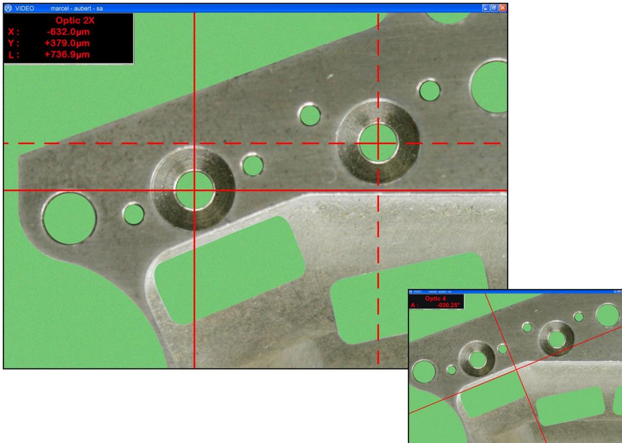
**VideoMES** ist eine einfache Softwarelösung zur Durchführung von Winkel- und Distanzmessungen. Im Modus "Winkelmessung" überlagert ein drehbares Fadenkreuz das Videobild, wobei der Wert des Winkels direkt angezeigt wird. Im Modus "Distanzmessung" werden die Distanzen, zwischen 2 verschiebbaren Punkten, horizontal, vertikal und diagonal gemessen, die Messwerte werden direkt angezeigt. Das System ermöglicht mehrere Kalibrierungen und damit die Verwendung von mehreren Objektiven.
