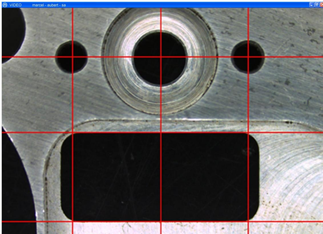
Die VideoGEN und die VideoGENsym Software erlauben die präzise Positionierung, Ausrichtung und Zentrierung von Werkstücken sowie Vorrichtungen und Gravuren. Diese Liniengeneratoren, welche per Tastatur gesteuert werden, erzeugen drei qualitativ hochwertige Linienpaare (vertikal und horizontal) auf einem digitalen Videobild. Mit der universellen Basissoftware VideoGEN können die Linien unabhängig voneinander in einem gewünschten Bereich bewegt werden.
