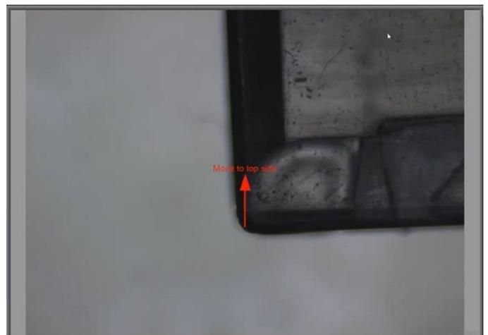
2 Bewegen Sie den Messtisch, wie vom roten Pfeil angezeigt, zu den vier Ecken des Rechtecks. Tippen Sie bei jeder Ecke auf den Bildschirm oder auf ENTER. Anschließend wird das Dialogfeld angezeigt.
