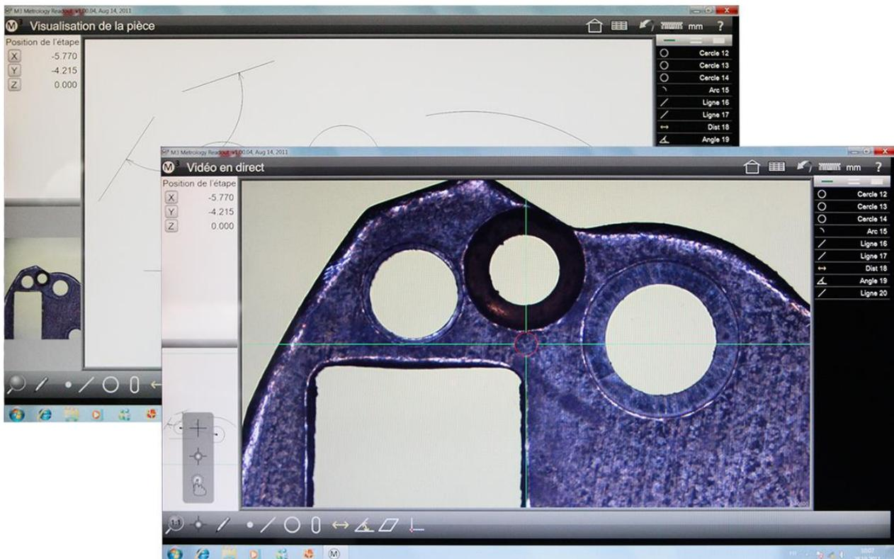
Le logiciel M3 est l'outil idéal pour réaliser des mesures rapides en série avec une caméra digitale et un système d'analyse d'image de la dernière génération.
